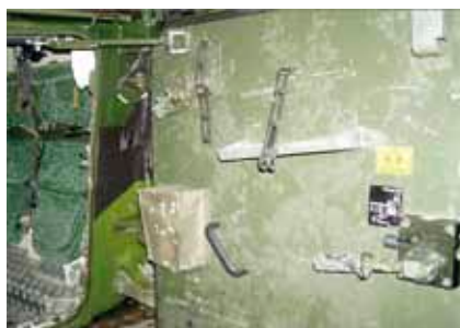
Lägg märke till att det finns mögel på alla ytor, såsom textil och stål.
